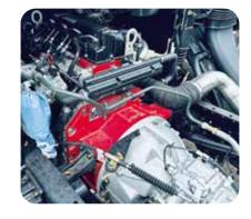
Motor original Cummins de bajo peso , optimo cilindraje y alto torque ,cumple normativa Euro V , tiene sistema de inyección riel común marca BOSCH
